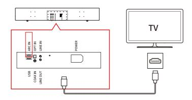
注意: 请确保您的电视上的 HDMI ARC 功能已开启。
