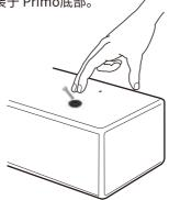
步骤 5: 打开主电源开关。
