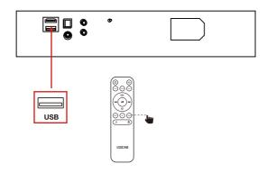
请注意: USB接口:支持USB1.1(FS)、支持磁盘格式: FAT32、容量: ≤ 64G(更大的存储空间会影响加载时间)、未来可以通过USB端口进行固体升级。
